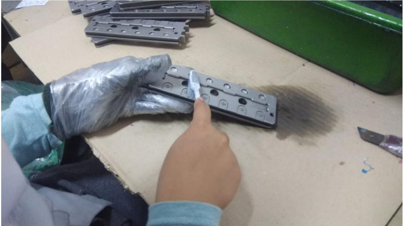
Reinigung eines Werkzeugs für die Produktion elektronischer Komponenten mit chemischen Mitteln mit starkem Geruch und gesundheitsschädigender Ausdünstung © LIPS
