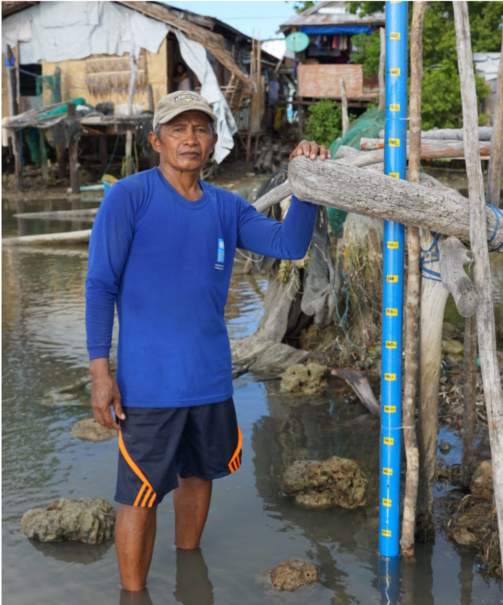
Ein kostengünstiger Gezeitenmesser, der von Expert*innen der Visayas State University und der lokalen Gruppe in Guiuan entwickelt wurde © Eduardo Mangaoang/VSU
